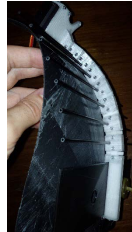
Figura 2. Sistema fabricado mediante técnicas de prototipado rápido (impresión 3D) y material compuesto.
