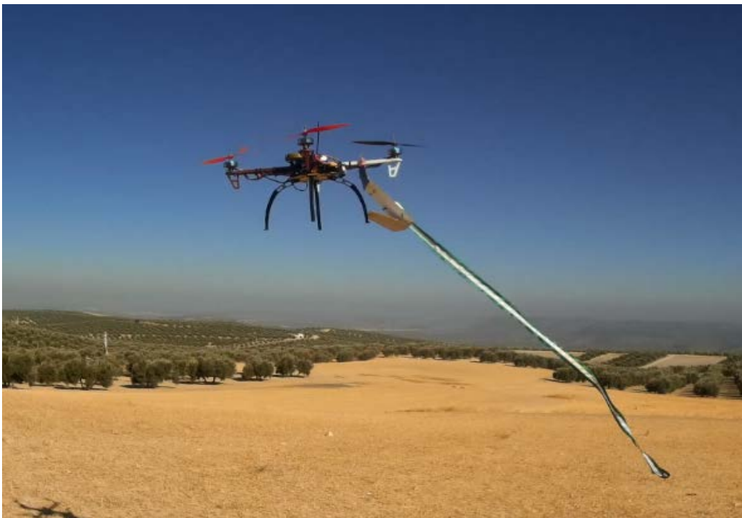
Figura 3. Pruebas experimentales realizadas. Se consigue la deflexión del aire, dirigiéndolo de forma exclusiva a la plantación, eliminando el producto derivado.
